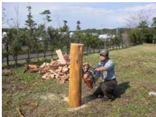
片面をフラットに切り、底を作る。
